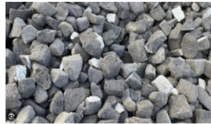
Abb. 169 - Recycling Baustoff Glasschaumschotter
