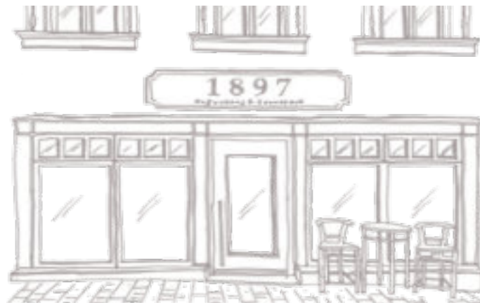
Abb. 85 - Großformatige Glasflächen sollten entweder durch Mauerwerkspfeiler in einzelne Fenster oder durch Holzrahmen unterteilt werden, so dass wieder hochrechteckige (stehende) Formate entstehen.
